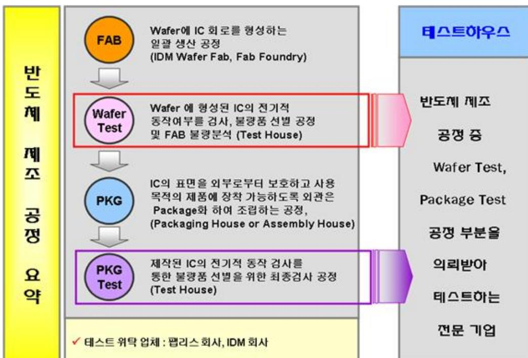
테스트하우스는 반도체 제조 공정상 맨 마지막에 위치하므로, 반도체 칩의 양품, 불량 판별뿐 아니라 문제 발생시 어느 공정에서 문제가 되는지를 판별해 주는 역할을 수행하고 있습니다. 이는 반도체 산업내에서 테스트하우스의 전문성이 요구받는 사항이기도 합니다.
